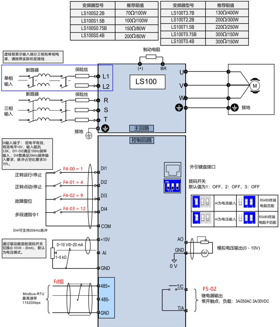
图 2-1 单相 / 三相电源输入 (LS100S0.4B~LS100S2.2B, LS100T0.4B~LS100T3.7B) 端子接线图
