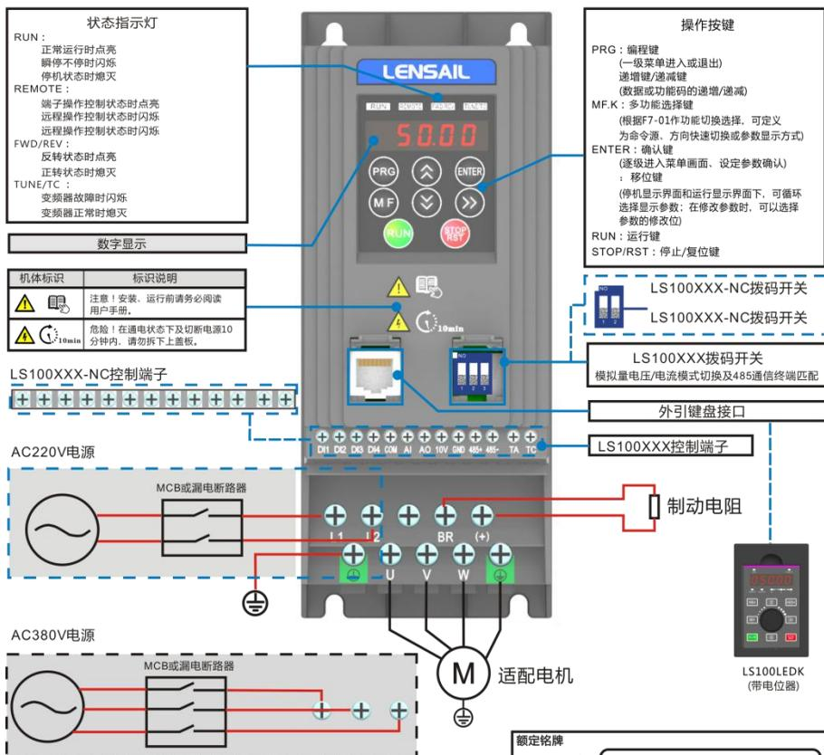
注：虚线框中内容是分三相输入和单相两种机型，请按实际机型端子进行接线。
