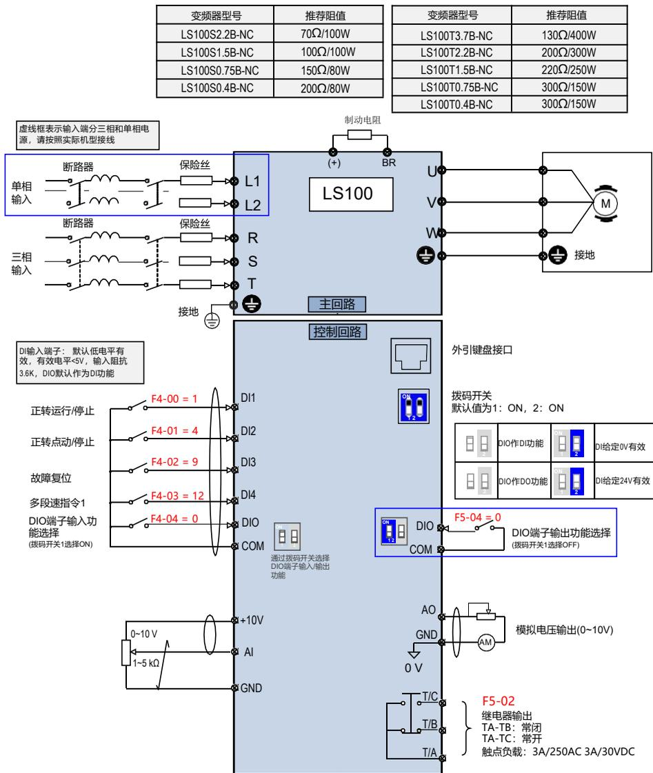
图 2-2 单相 / 三相电源输入 (LS100S0.4B-NC~LS100S2.2B-NC, LS100T0.4B-NC~LS100T3.7B-NC) 端子接线图
